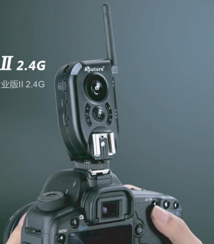
Ajustes recuerdan Trigmaster Plus II (TP2) es un transmisor y receptor de Sistema integrado en una unidad de tamaño de bolsillo. Utiliza una señal 2.4G común flashes Speedlite de disparo, y cámaras.
